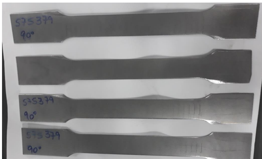
Figura 15 – Corpos de prova utilizados no ensaio de tração. Todos foram fornecidos marcados pela sua orientação. Nota-se falta de padronização em seus formatos.
