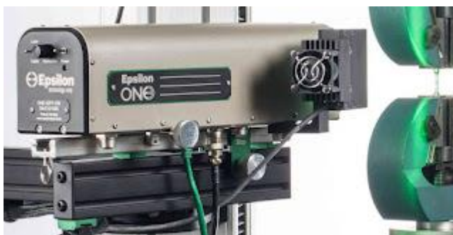
Figura 11 - Extensômetro de vídeo modelo Epsilon acoplado a uma máquina de ensaio universal
