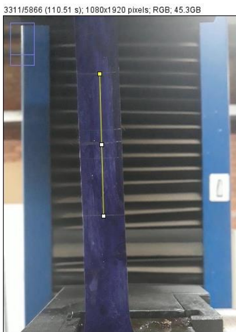
Figura 16 – Instante t_0 (sem deformação). Média do comprimento calculada em: 536,842 pixels.
